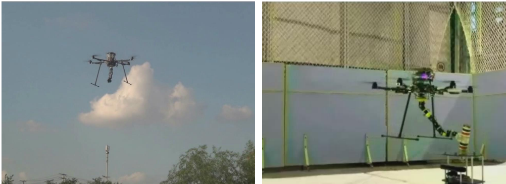
旋翼飞行机械臂及成功实现动目标跟踪抓取
