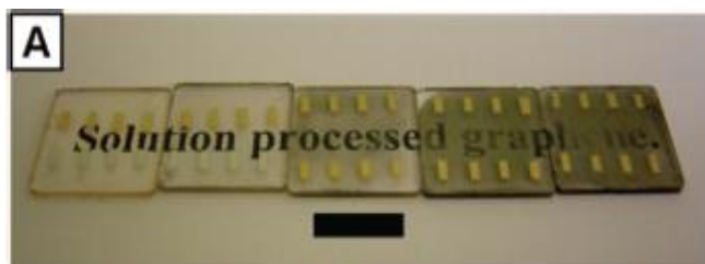
图 5、基于石墨烯的透明电极材料
