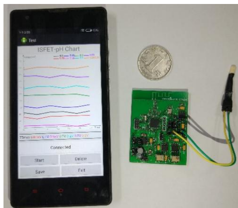
基于 ISFET 传感电路和 BLE 通讯电路的低功耗智能硬件系统
