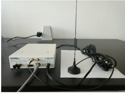
图 2 利用 USRP 搭建的移动基站
