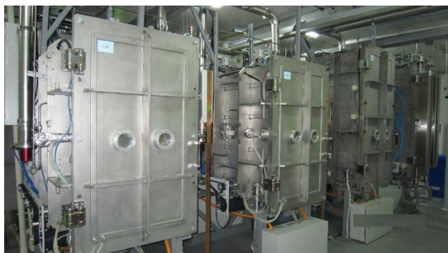
图1：年产能2兆瓦的非晶硅/非晶硅锗/微晶硅三结叠层薄膜太阳能电池生产线的核心PECVD设备
