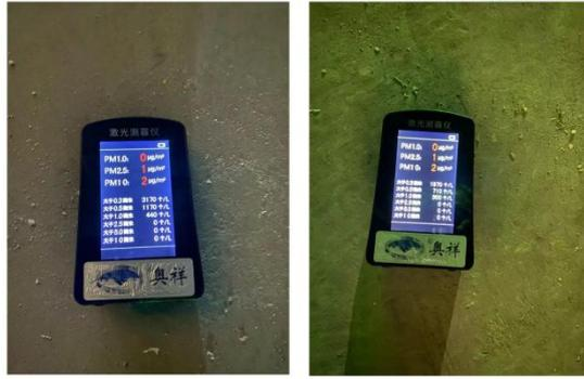
证实了稳态置换流送风末端可使流动的空气可产生（沿地面的“贴附”）效应
